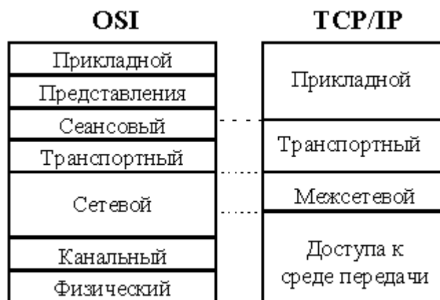
Рис. 2.4. Соотношение уровней стеков OSI и TCP/IP
