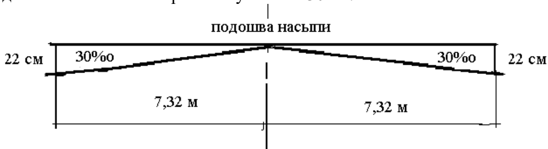
Рис. 5. Схема срезки грунта подошвы земляного полотна
