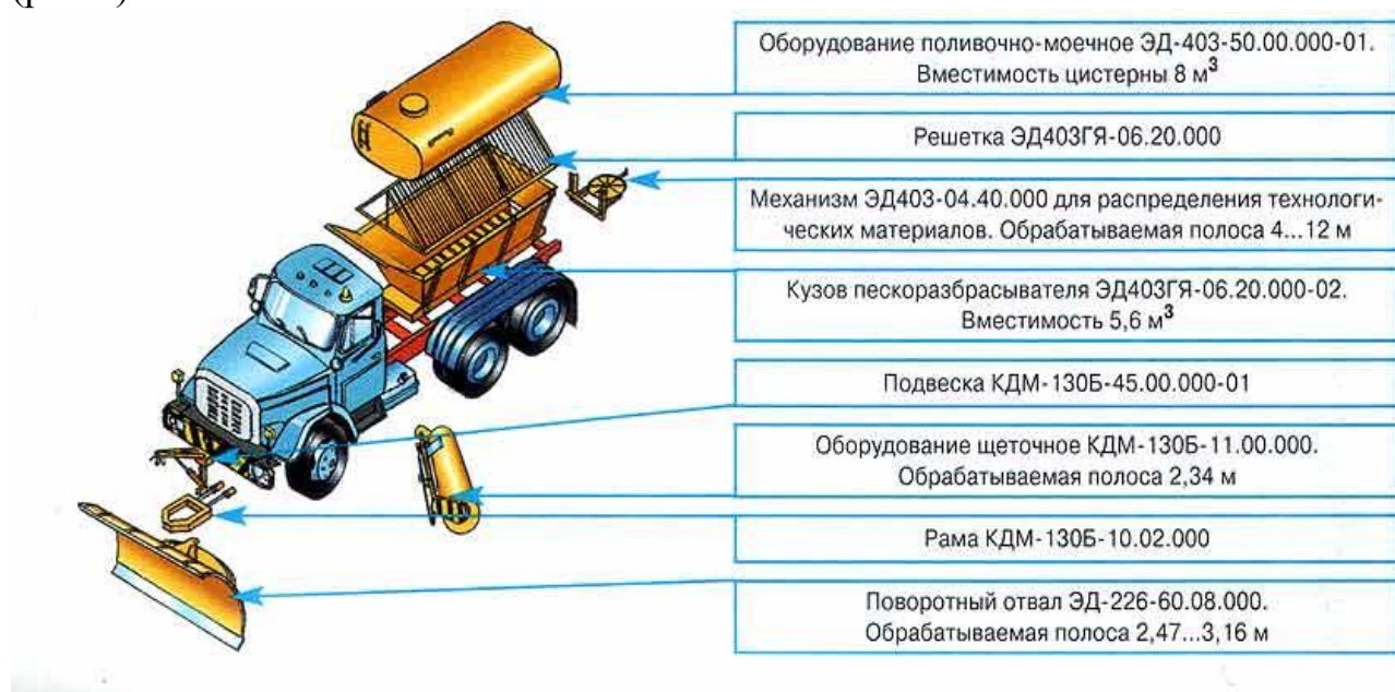
Рис.9. Плужно-щёточный очиститель КДМ-130Б
