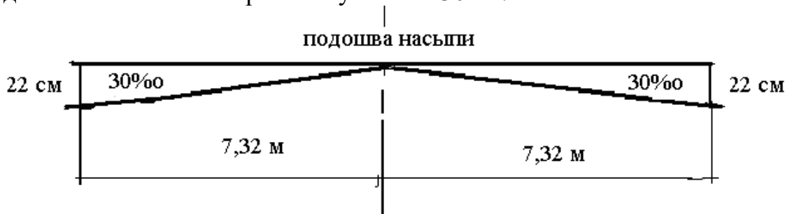
Рис. 5. Схема срезки грунта подошвы земляного полотна
