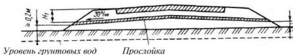
Рис.2.10.7. Конструкция влагоизолирующей прослойки
